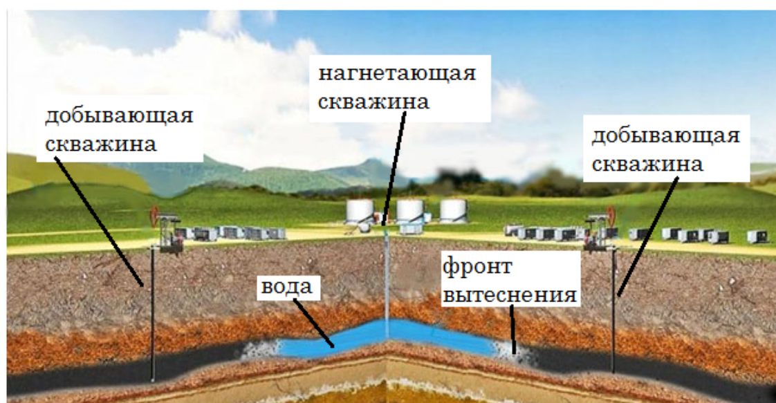
Рис. 19. Технология нефтедобычи: вытеснение нефти водой.
